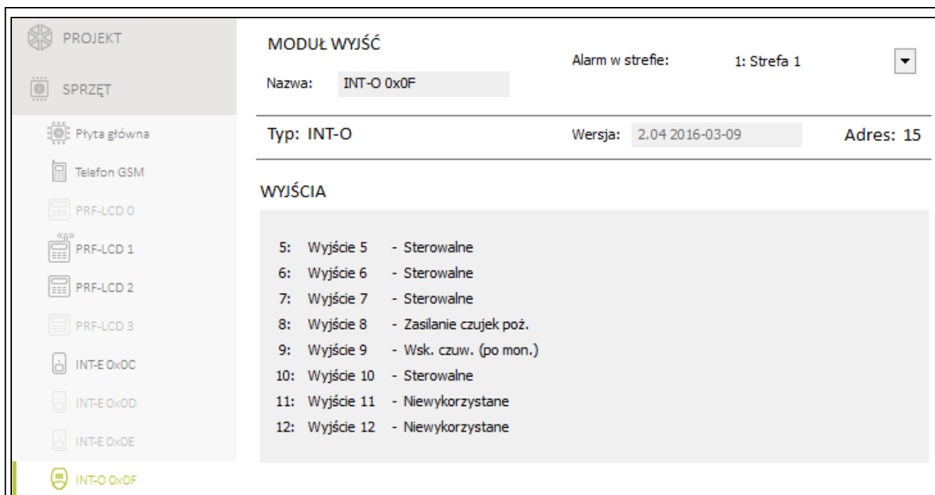
Rys. 13. Zakładka z ustawieniami ekspandera wyjść.
